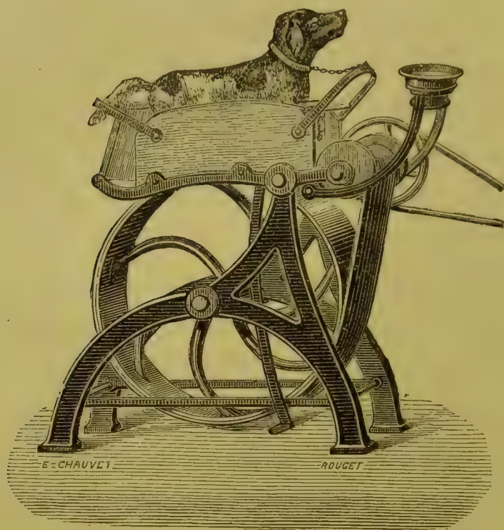
Fig. 262. Macchinetta motrice messa in azione da un cane.
